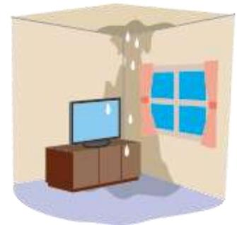
屋根の形状は問わず起こるすが漏れの特徴は、軒先につららが多、軒天に雨染みがあるなどの現象が見られます。すが漏れの対策として、雪を解かさないように屋根断熱の強化や積もらせないように勾配をつけることが得策のようです。
